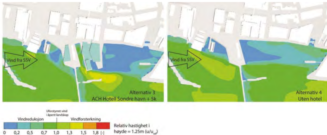
Figur 8 Illustrasjon av vindbelastning 1,25m over havflaten i omkringliggende innseiling og havnebasseng ved vind fra Sør-SørVest, hentet fra konsekvensutredning Mack Øst-planen
